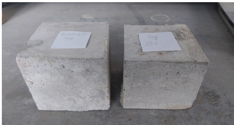
Рис. 1. Контрольные образцы габаритами 100x100x100 мм: слева – с применением добавки, справа – без применения добавки
