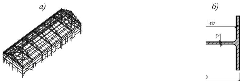
Рис. 1. Исследуемый объект а) общий вид каркаса здания; б) сечение стальной колонны из двутавра 35К2
